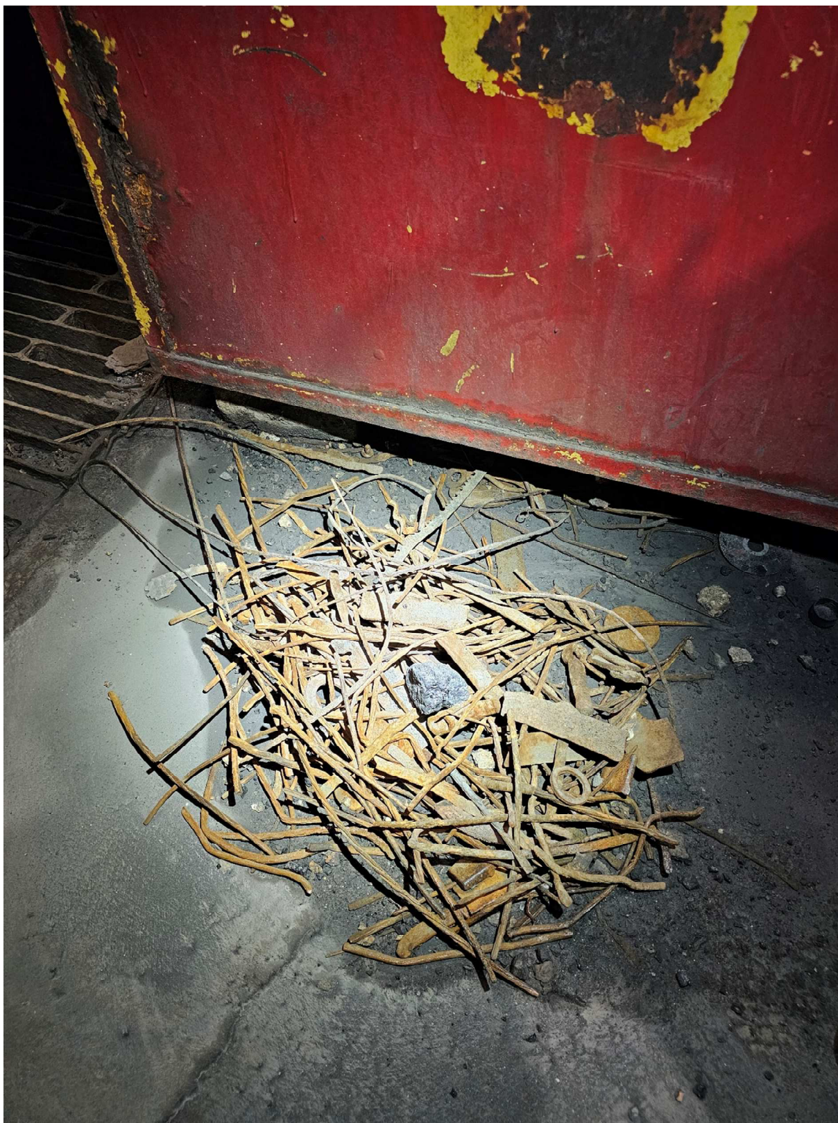
Fot. 6. Zdjęcie przedstawia widok prętów zbrojeniowych, które skorodowały i odpadły, pręty zebrane zostały z posadzki w poziomie przyziemia.
